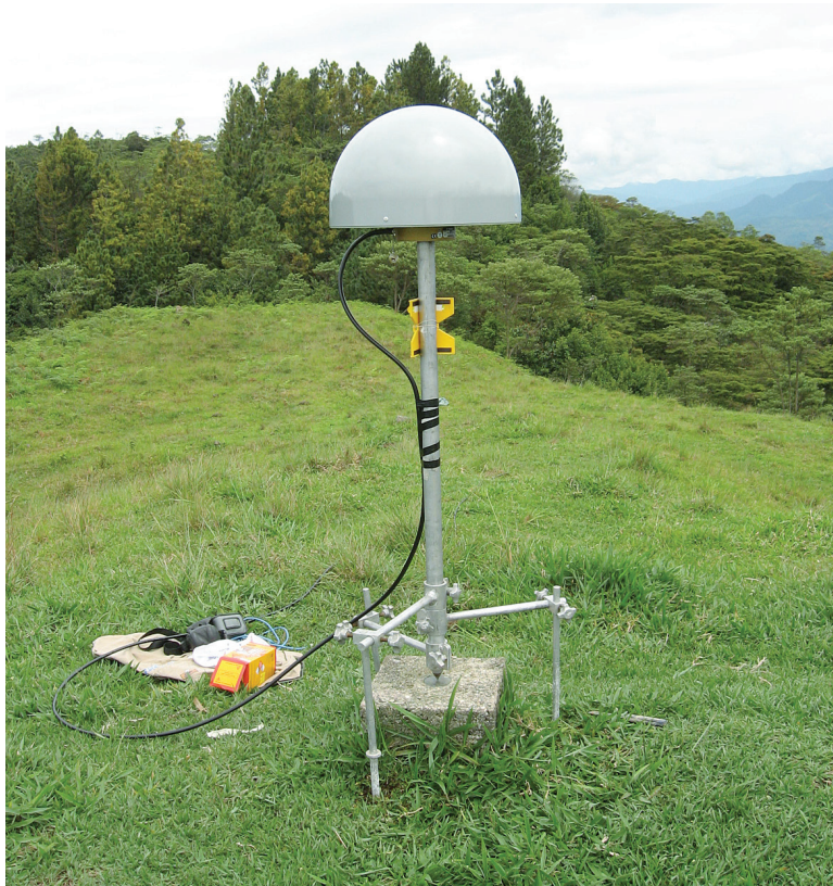
► Figura 2. Sistema de montaje de antena GPS para la toma de datos empleando sistema de altura constante (spike-mount) de un metro. La foto corresponde a la estación BVIS.
