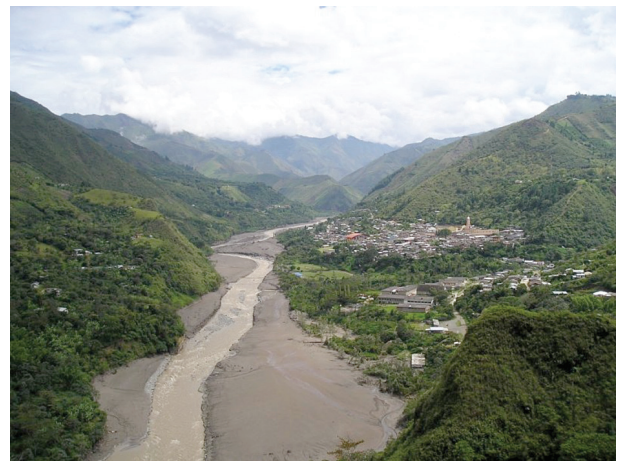
► Figura 2. Depósito del flujo de escombros ocurrido en la cuenca del río Páez en el 2007 en la población de Belalcázar.
