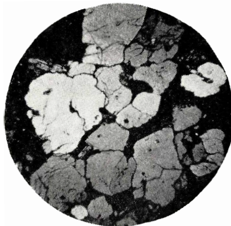
Microfoto de otra parte de la misma muestra (Hu-61). Los efectos de la propilitización han afectado casi toda la roca. El mosaico de cuarzo se asemeja mucho a la estructura de cuarzitas. ( \times 40 ).
