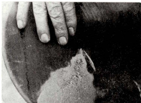
FIG. 7. Beneficio de Au y Ag utilizando el molino de pisones (antioqueño). Detalle del oro concentrado en la batea.
