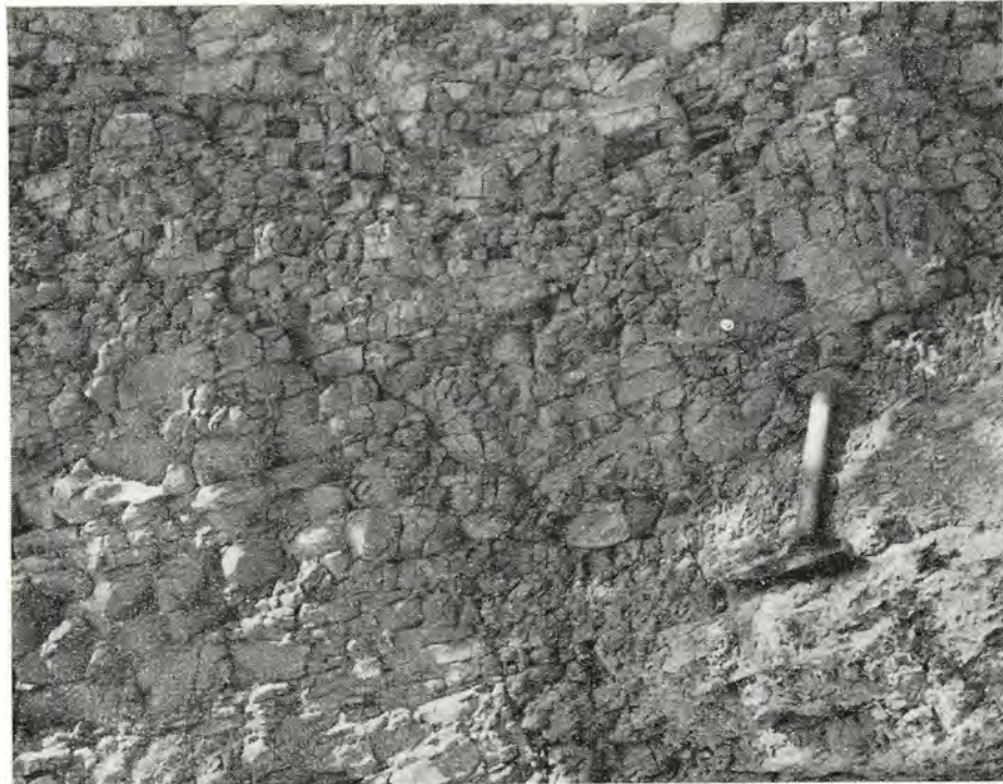
Fig. 10.—Arcillas margosas arenosas (K 2b) del Campaniano Superior al lado de la carretera Girardot-Nariño.
