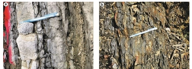
Figura 29. Lodolita y arenisca del intervalo L. (a) Areniscas en capas delgadas, macizas (localmente con laminación ondulosa), separadas por arcillolita de poco espesor (metro 690,5; azimut 320°). (b) Lodolita gris con interlaminaciones onduladas limoso-arenosas amarillentas (metro 687,3; azimut 320°).
