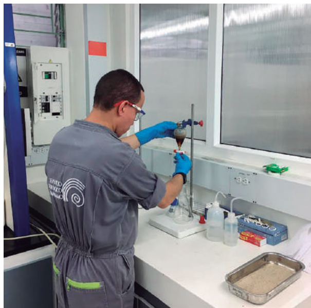
Figura 9. Separación de circones por líquidos densos (LST) Fuente: autores
