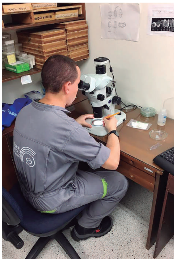
Figura 10. Separación de circones en vidrio Fuente: autores
