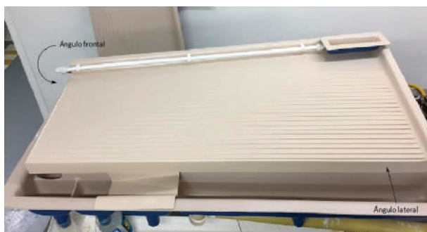
Figura 4. Ángulo lateral y frontal de la mesa Wilfley Fuente: autores
