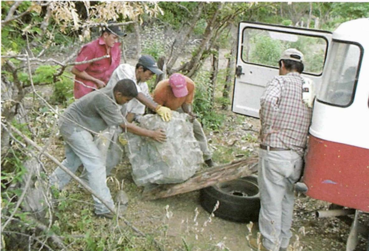
**Figura 6. Tamaño de un bloque de granito requerido para efectuar los análisis de caracterización geomecánica del material. Sitio de muestreo, cerro de Las Palomas.**
