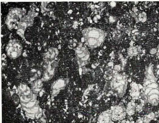
Foto 3. - Sección delgada de la capa limítrofe entre el Santoniano y el Campaniano, en el Alto del Trigo (muestra DB-471). Lutita arenocalcárea, con el 11.16% de  $P_2O_5$ . En una matriz arcillofosfática flotan conchas de foraminíferos: *Wheelerella magdalenaensis* (Petters) y *Anomalina redmondi* (Petters). La colófana forma oolitas en la matriz y reemplaza algunas veces la calcita de las conchas pequeñas.
