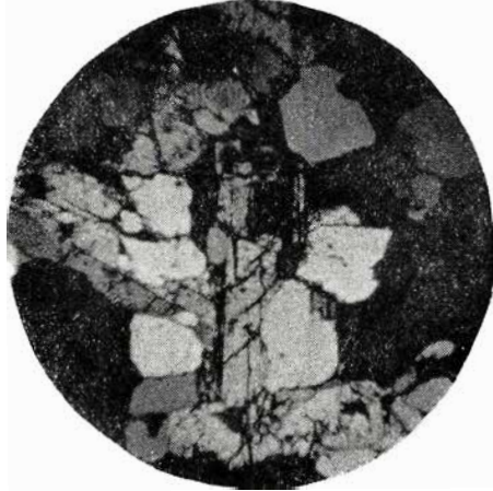
Microfoto de una diabasa (Hu-61), en la cual la plagioclasa está parcialmente sustituida por cuarzo. ( \times 40 ).
