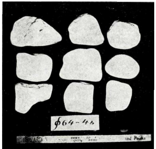
Fig. 2.— Fragmentos de caliza en varios estados de abrasión. Segundo experimento, 16 mm de diámetro.
