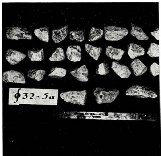
Fig. 4. — Fragmentos de caliza en varios estados de abrasión. Segundo experimento, 64 mm de diámetro.
