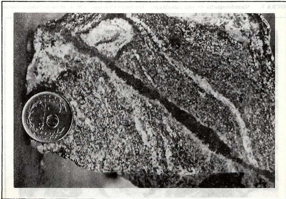
FIGURA 5. Migmatita cruzada por una vena de epidota. Obsérvese la textura nebulítica y plegada. Quebrada Agualimpia, 400 m al S 40° E del Alto Peña de Oro.
