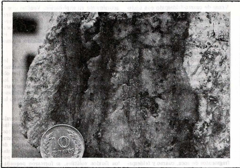
FIGURA 16. Roca granítica con vena de cuarzo. Las cavidades se han originado por disolución de los sulfuros. Río La Baja 150 m aguas arriba de la desembocadura de la quebrada Chicaguá.
