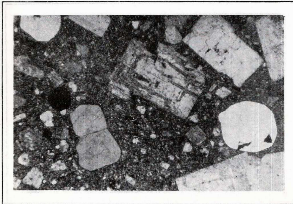
FIGURA 11. Microfotografía del pórfido dacítico. 15 X.
