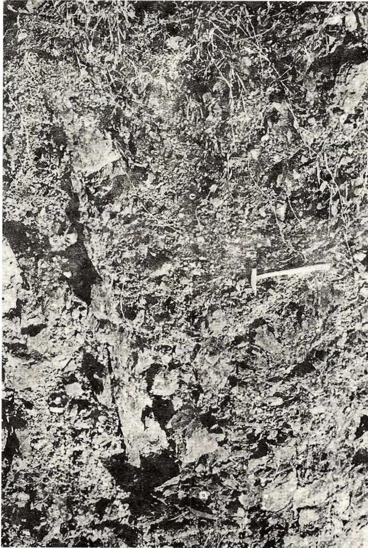
Figura 24-A. Falla de intrusión de Balsadero. Neis brechado y cizallado, a 15 m al noroeste de la falla. Cantera para triturado de vías en la confluencia de los ríos San Carlos y Guatapé (c-10). Fotografía de T. Feininger.
