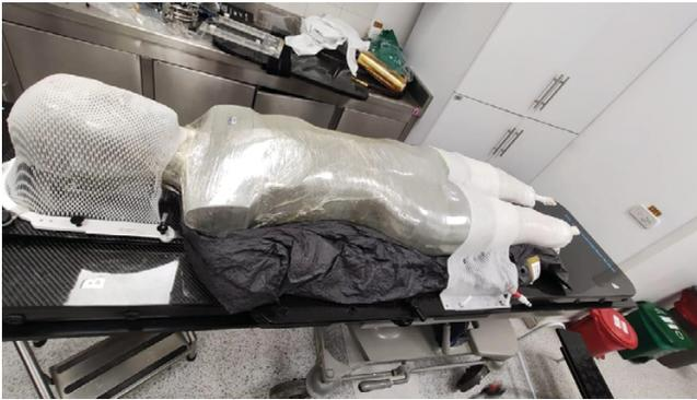
**Figura 2.** Inmovilización de simulador anatómico CIRS con extremidades construidas con parafina de uso clínico
