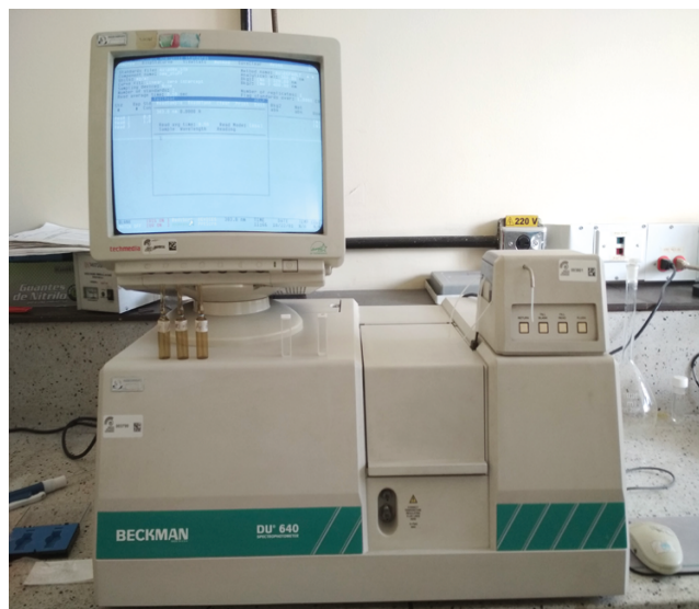
Figura 4. Sistema dosimétrico compuesto por el espectrofotómetro BECKMAN DU-640 y los dosímetros de ampollita
