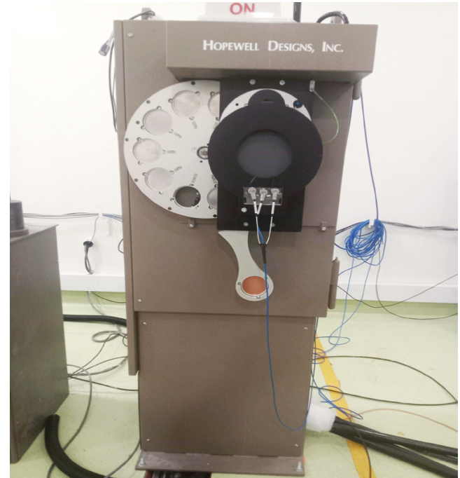
Figura 2. Sistema de irradiación para la caracterización de la respuesta en energía de los dosímetros Fricke preparados según la norma ISO/ASTM (ISO/ASTM, 2015)
