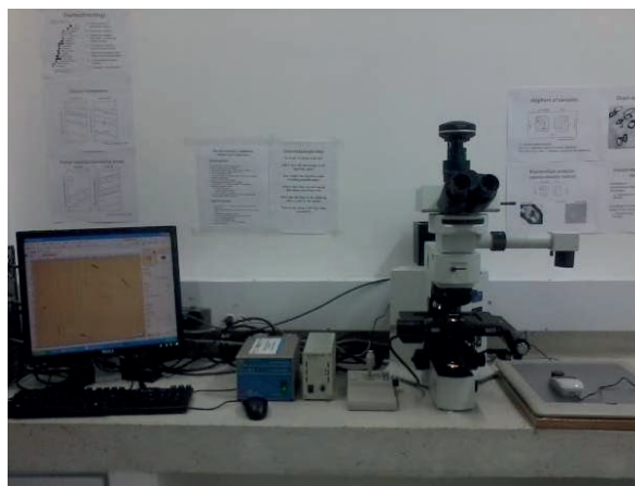
Figura 2. Sistema FT Stage para el conteo de huellas de fisión del Servicio Geológico Colombiano
