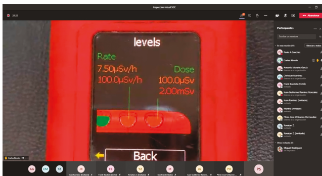
(a) Verificación alarma dosímetro de lectura directa
